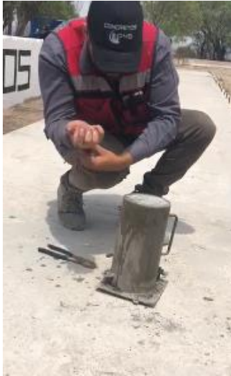
Prueba de revenimiento – Agua de biodigestor - Figura 15
