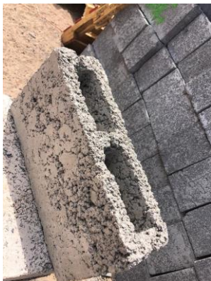
Bloque hecho con agua potable "de la llave" - Figura 11
