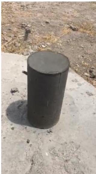
Prueba con agua directa de pipa – trabajo de colado - Figura 14
